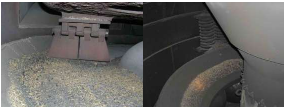
Fot. 1. Odkładanie się biomasy na wewnętrznych elementach młyna
